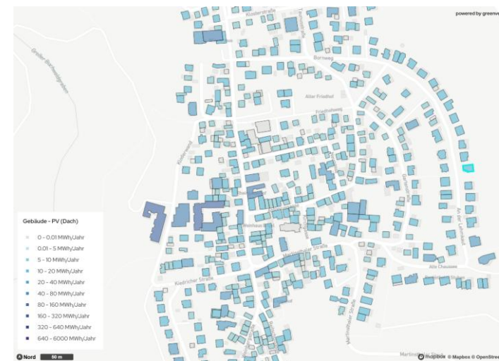
Beispielhafter Ausschnitt des technischen PV-Dachflächenpotenzials
